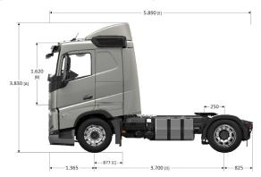
[A] Altura total [B] Altura libre sobre túnel de motor [C] Ancho desde centro de eje direccional a final de chapa de cabina [D] Distancia entre ejes (opcional 3500 mm) [E] Largo total (variable según [D]) Todas las medidas son de referencia, para mayor detalle consultar con Ingeniería de Ventas.
